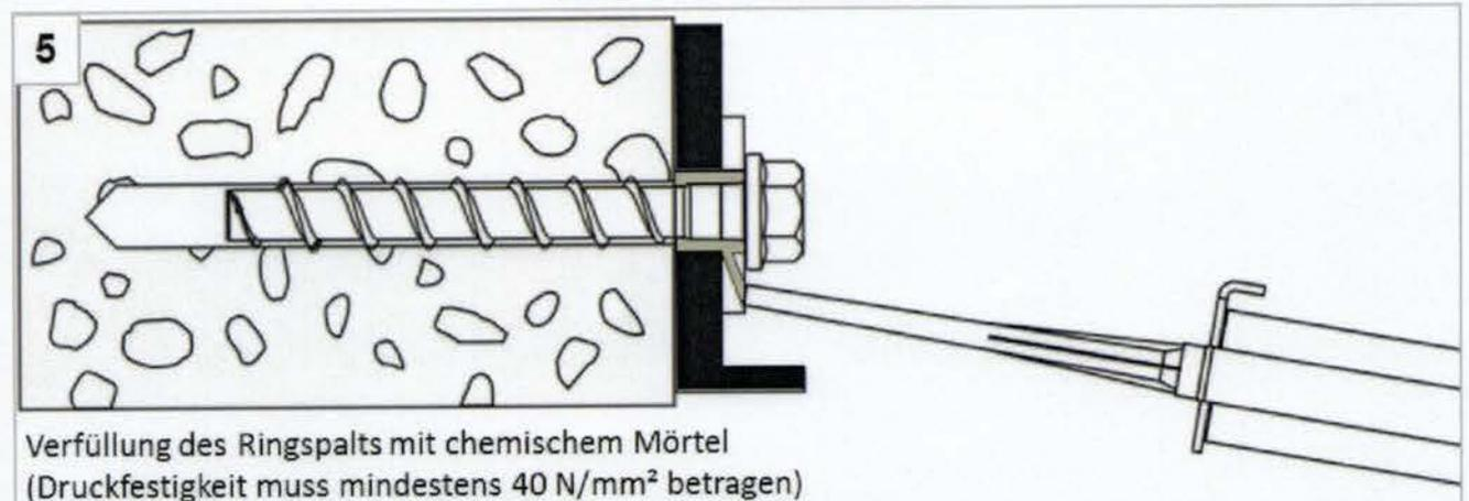
Verfüllung des Ringspalts mit chemischem Mörtel
