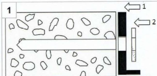
Nach Bohrerherstellung (Anhang B5), zuerst das Anbauteil (1), dann die Verfüllscheibe (2) positionieren
