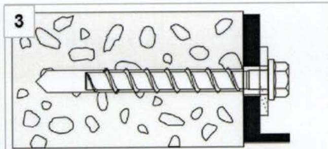
Einbauzustand ohne verfüllten Ringspalt
